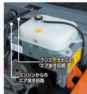
エキスパンションタンク
