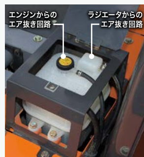
エキスパンションタンク
